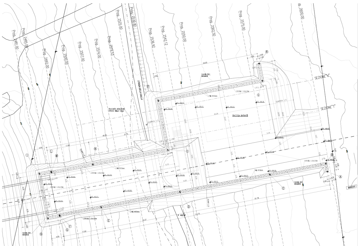
Pianta scavi imbocco Est
