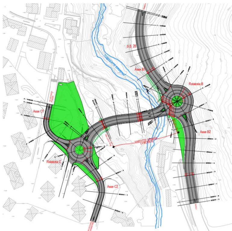
Figura 2.3 Asse secondario – Collegamento Rione Borgato con S.S.28
