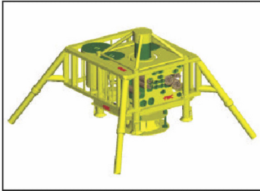
Fig. 3 - Esempio di Struttura protettiva
