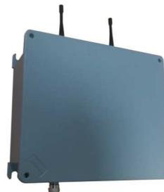
L'antenna attiva comunicherà con la centralina di controllo attraverso un bus RS485 così da poter essere posizionata fino a circa 800 metri dalla posizione della centralina.
