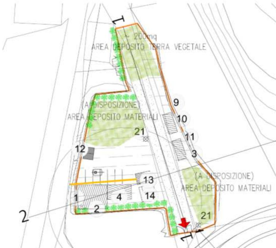
Figura 143: Asse secondario Viabilità rione Borgato – LAYOUT cantiere operativo 3
