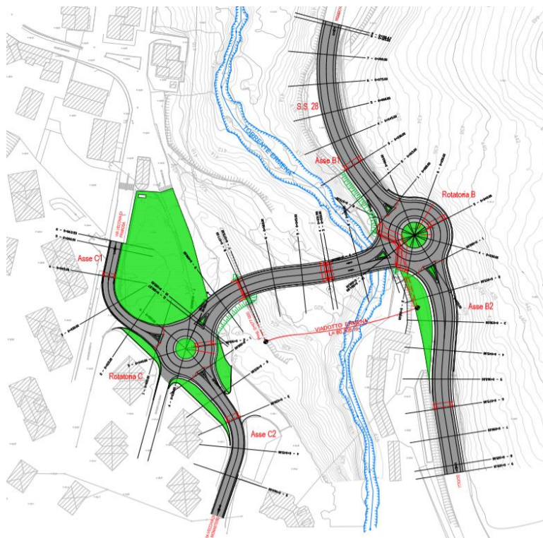
Figura 4.2 Asse secondario – Collegamento Rione Borgato con S.S.28
