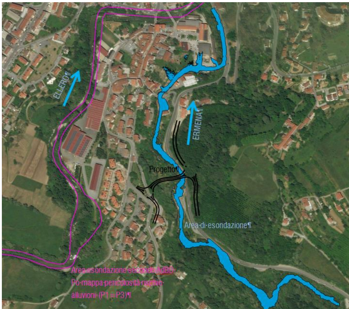
Figura 3.12: Area di esondazione modellata del torrente Ermena con Q_{Tr200}=112 \text{ m}^3/\text{s} . Si evince l'assenza di mappatura inerente all'area di esondazione del AdBD del Po (dalla relazione idraulica di progetto)
