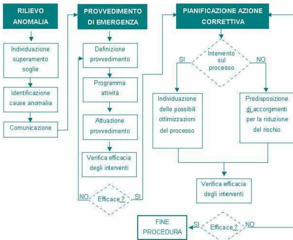
Processo di gestione delle anomalie. Fonte: ISPRA - Linee Guida per la predisposizione del Progetto di Monitoraggio Ambientale (PMA) delle opere soggette a procedure di VIA (D.Lgs.152/2006 e s.m.i., D.Lgs.163/2006 e s.m.i.) Indirizzi metodologici generali - Rev.1 del 16/06/2014.
