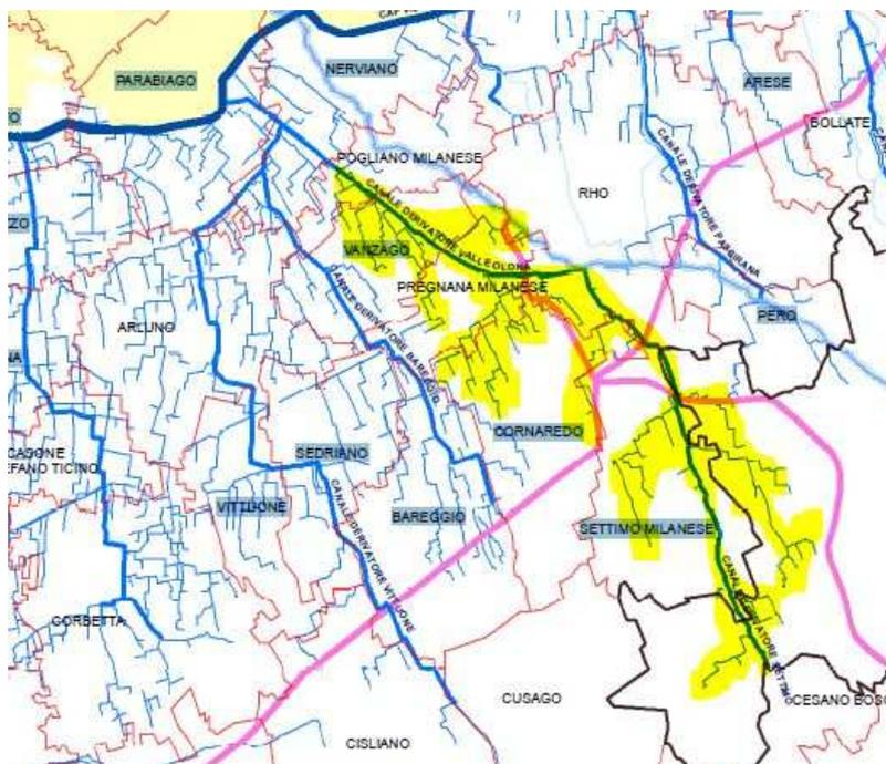
*Rete del Villorosi con evidenza dell'area impattata in caso di chiusura o di limitazione dell'efficienza del canale secondario Valle Olona per permettere le lavorazioni di spostamento legate al progetto ferroviario Rho-Parabiago.*
