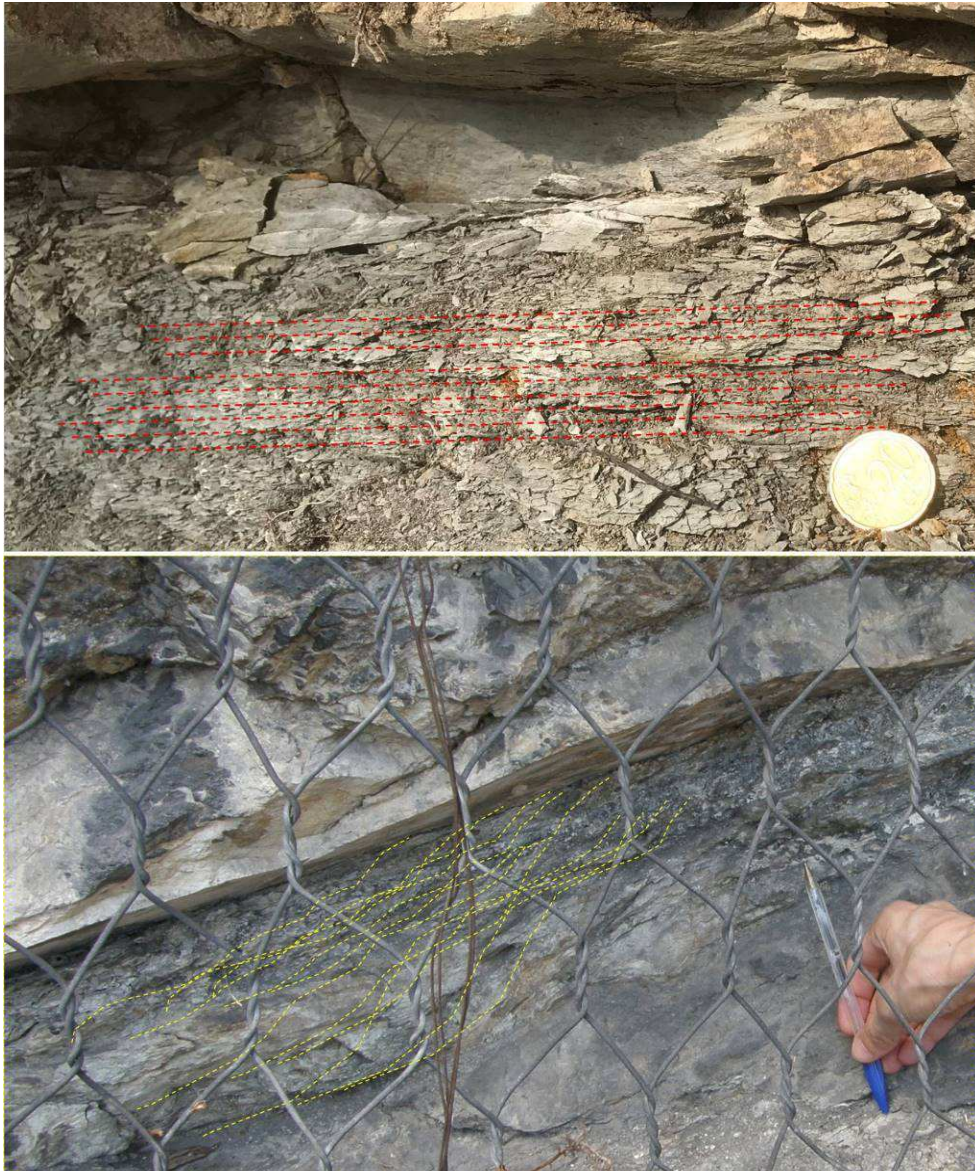
Figura 32 – Confronto due dettagli in cui i livelli marnosi del Medolo sono regolarmente "scagliettati" parallelamente (foto in alto) ed intensamente destrutturati ed ad andamento irregolarmente "uncinato" (in basso).
