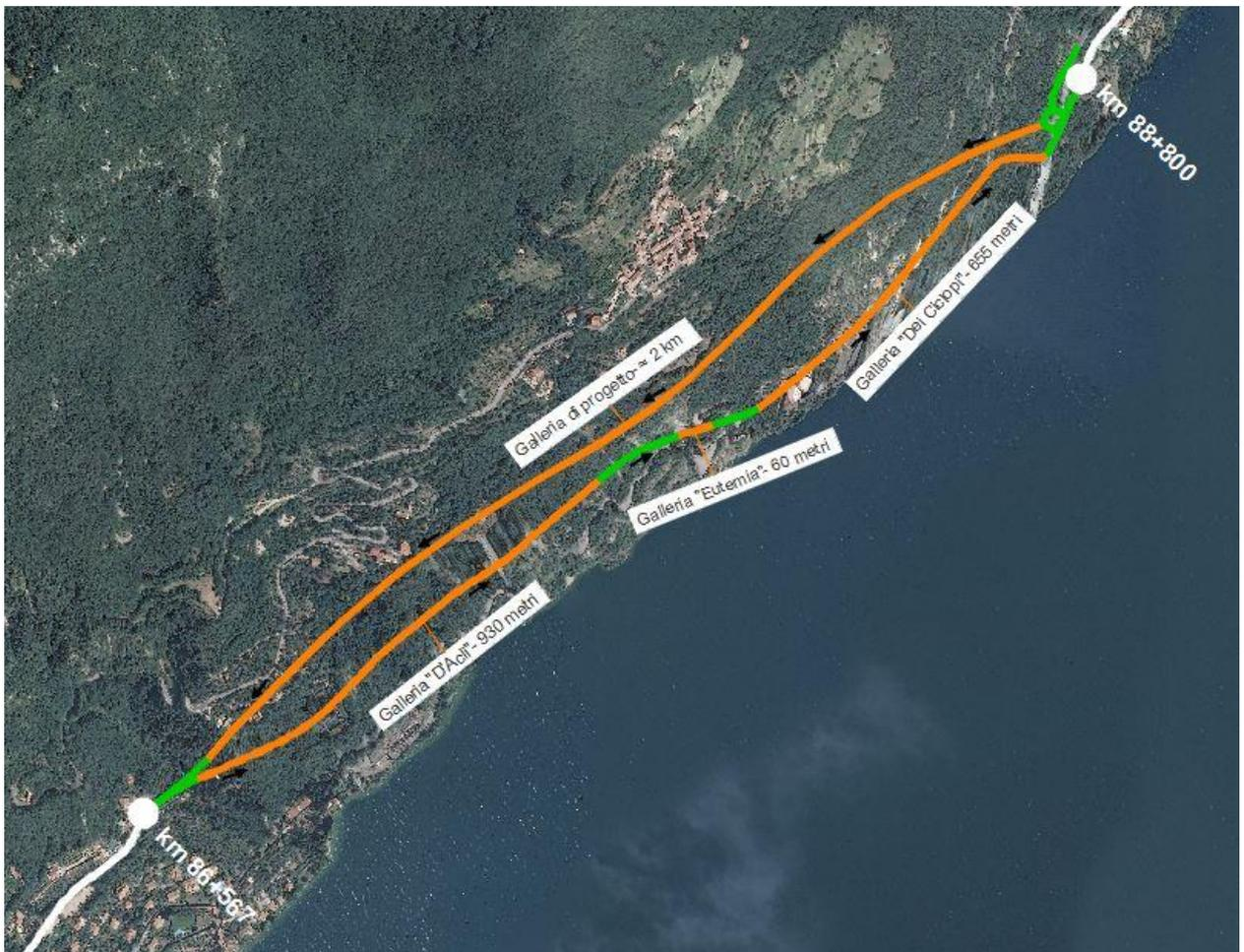
Figura 4-3 Rappresentazione rete stradale di progetto (SS45 bis dal km 86+567 al km 88+800) – Gallerie attuali utilizzate in un unico senso di marcia verso Riva del Garda e nuova variante in galleria utilizzata per senso di marcia verso Salò
