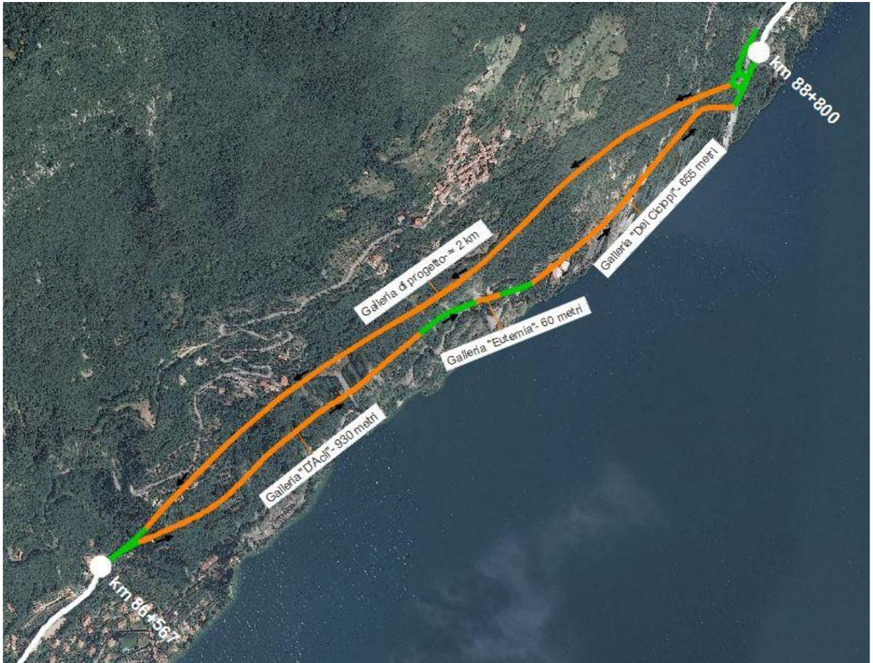
Figura 1-4 Rappresentazione rete stradale di progetto (SS45 bis dal km 86+567 al km 88+800) – Gallerie attuali utilizzate in un unico senso di marcia verso Riva del Garda e nuova variante in galleria utilizzata per senso di marcia verso Salò
