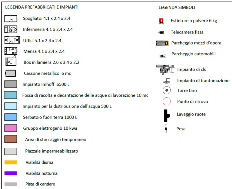
Figura 2-2 – Legenda del layout delle aree di cantiere base
