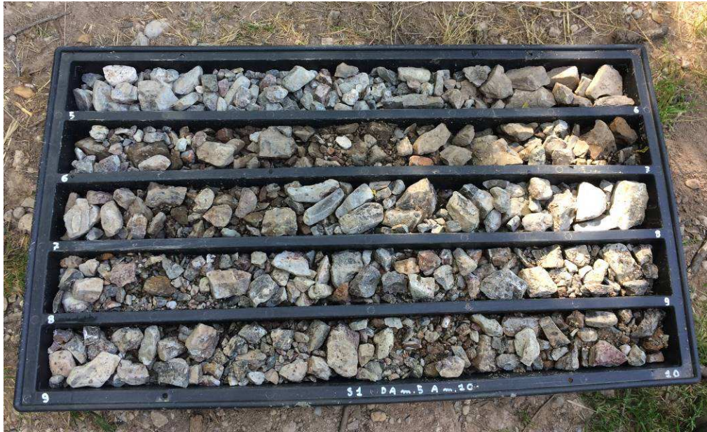
Figura 10 – Detrito incontrato lungo il sondaggio S1h orizzontale, da 5 a 10 m di profondità.
