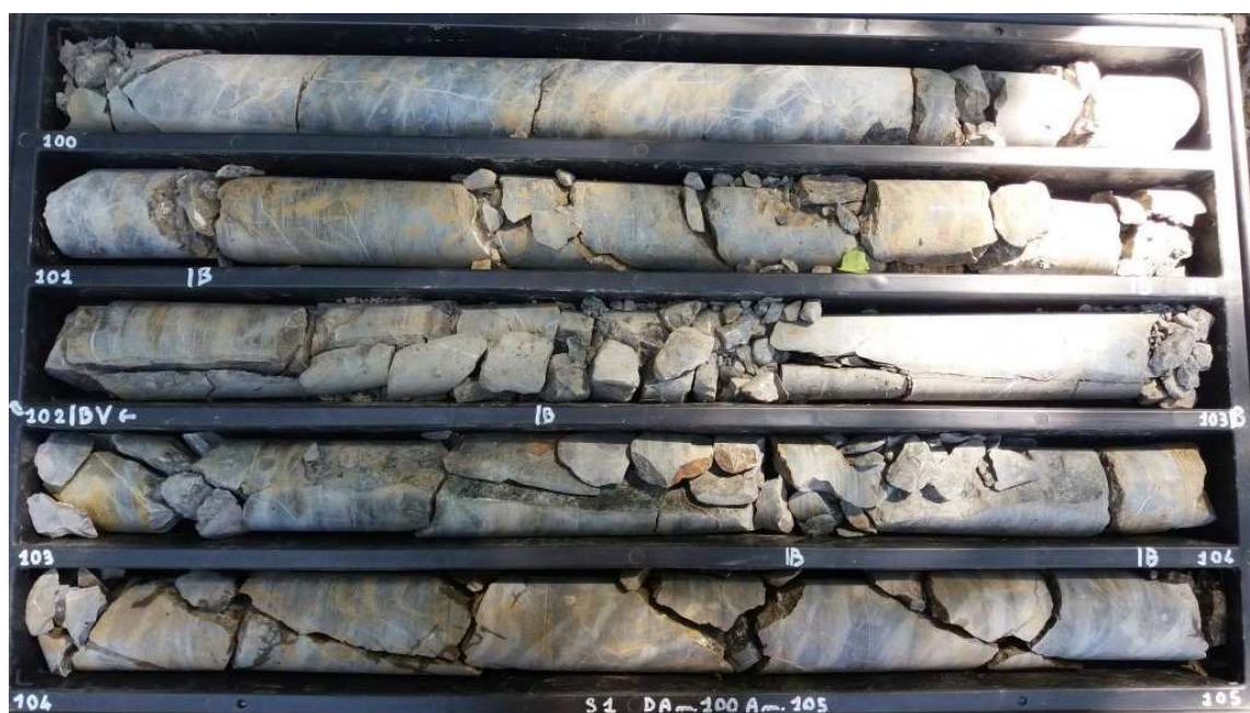
Figura 6 – Formazione di Concesio lungo il sondaggio S1h orizzontale, da 100 a 105 m di profondità.
