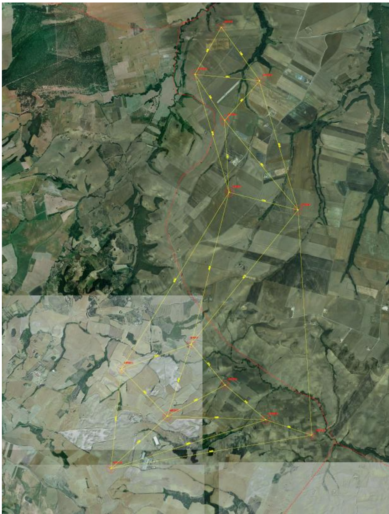
Figura 2-18: Estratto tavola A.16.b.1.2 Planimetria con distanze aerogeneratori
