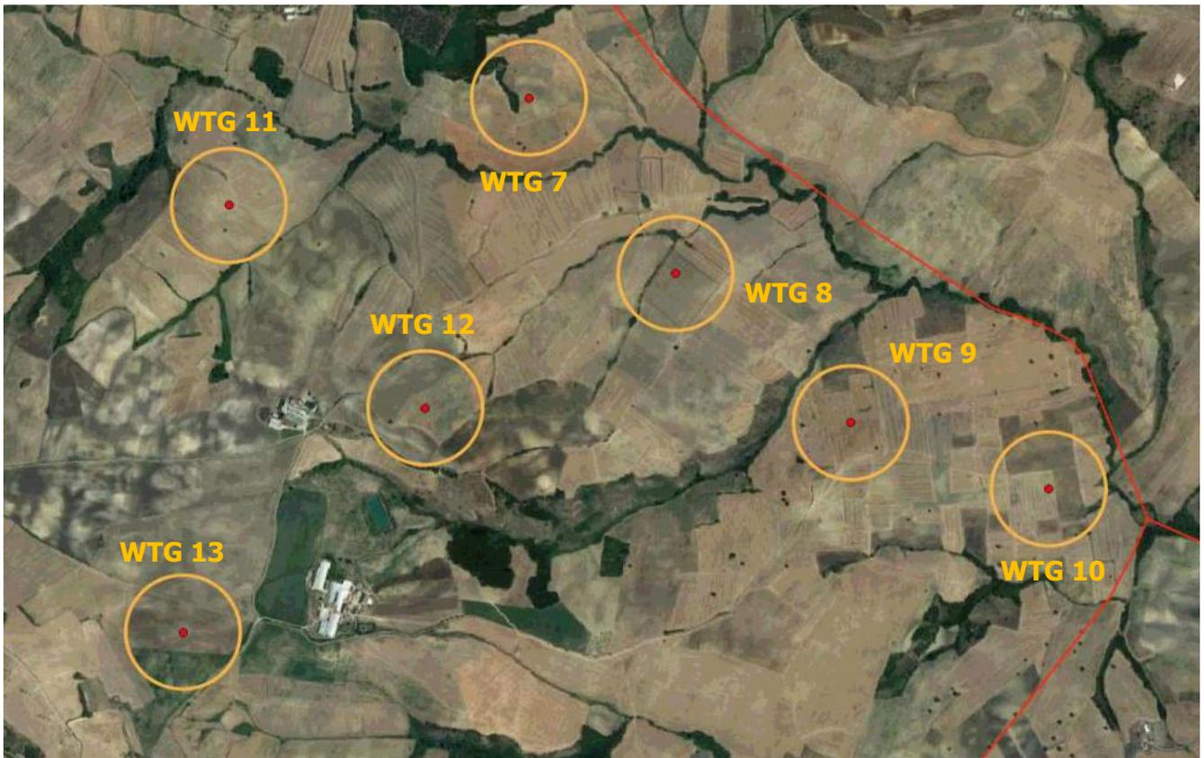
**Figura 2 –Indicazione della gittata massima della pala in caso di distacco: WTG 7 – WTG 13**
