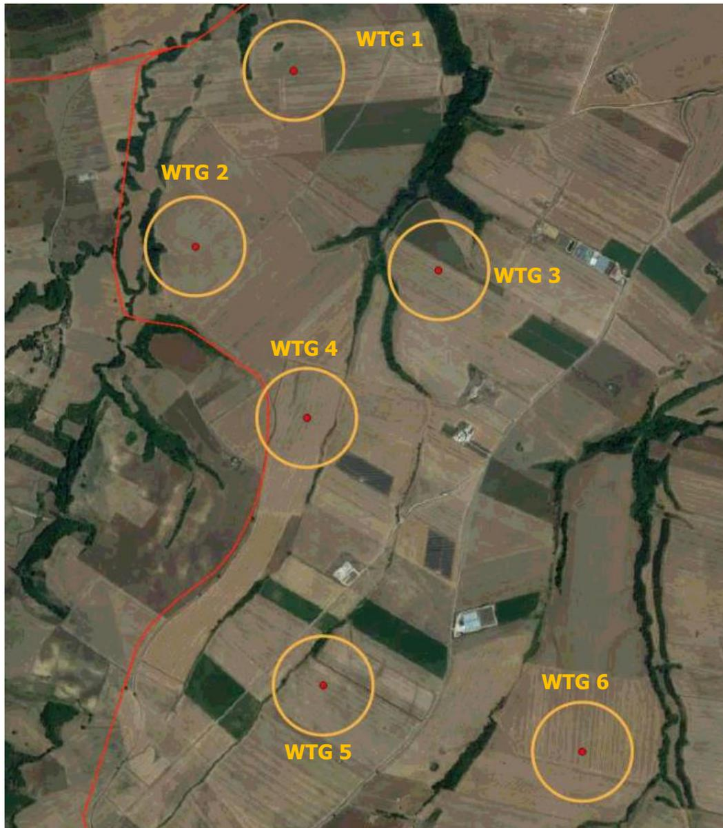
Figura 1 – Indicazione della gittata massima della pala in caso di distacco: WTG 1 – WTG 6
