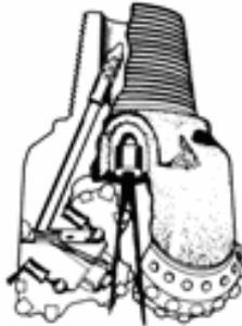
Figura 2.8 – Scalpello di Perforazione
