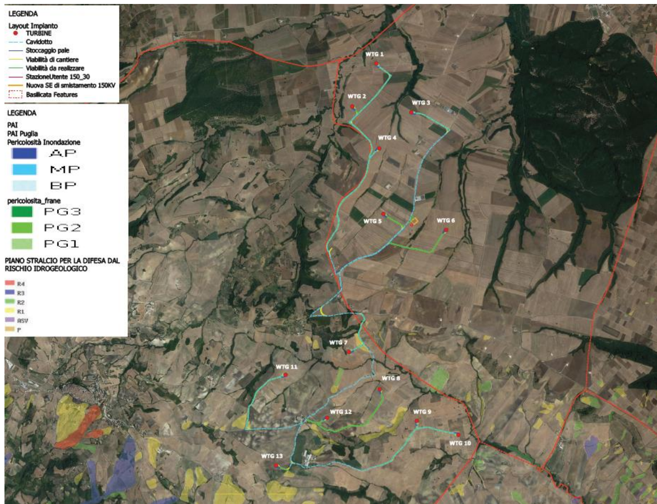
Figura 2-41 - Layout di Progetto rispetto con le perimetrazioni del PAI delle due Autorità di Bacino interessate
