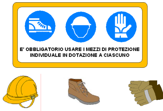
Esempio di segnalazione visiva di tipo cartellonistico affissa in cantiere
