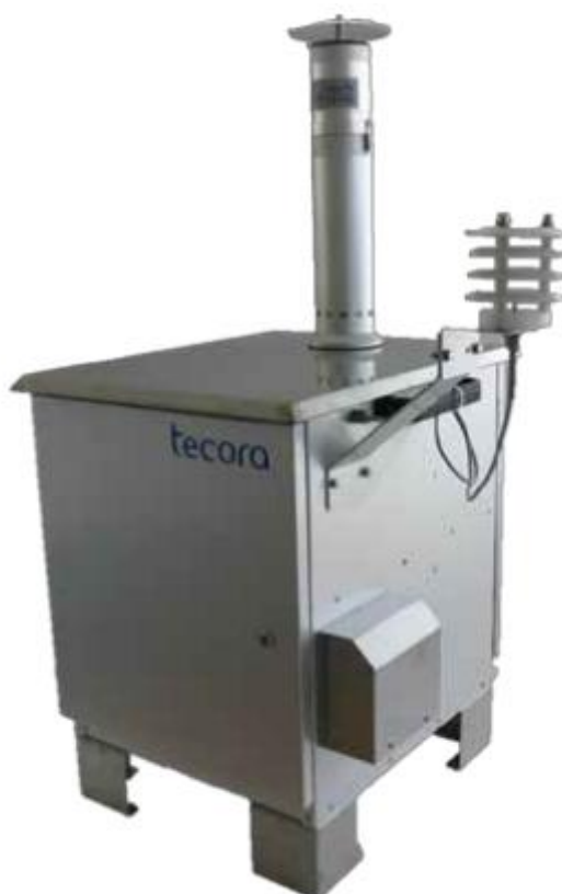
Figura 8: Campionatore con rilevamento sequenziale dei filtri (del tipo SKYpost PM FG)
