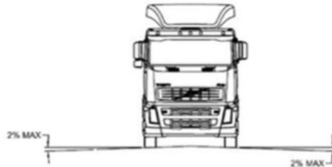
Figura 5. Illustrazioni prese dal “Wind farm Roads Requirements” della Vestas, relative alla pendenza longitudinale (a) e alla pendenza laterale della carreggiata (b).
