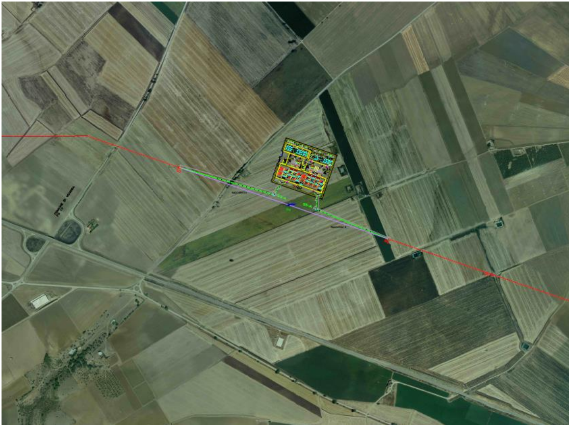
Figura 5 Inquadramento Stazione TERNA – connessione in entra-esci sulla linea 380kV Genzano Bisaccia
