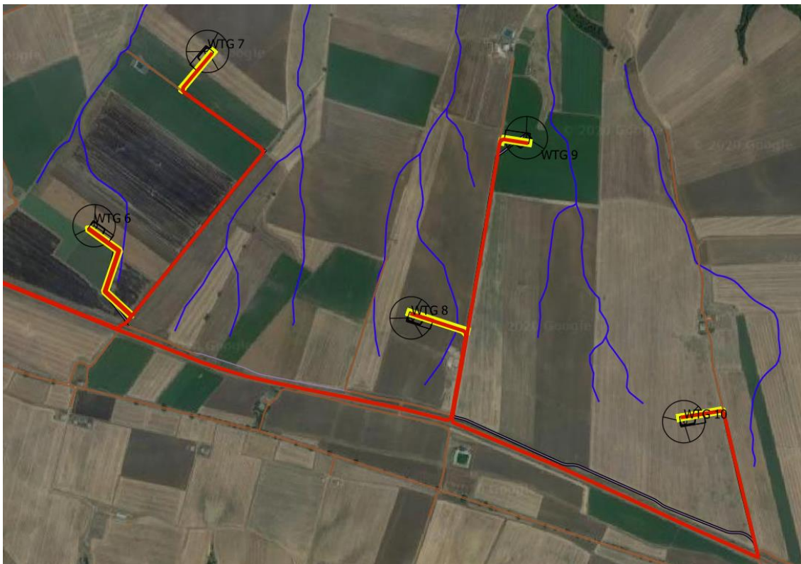
Particolare della Panoramica degli elementi costituitivi del parco: in rosso i cavidotti di collegamento, in giallo i nuovi tratti di viabilità, e in verde la cabina elettrica in blu i reticoli idrografici riportati nella cartografia IGM 1:25.000 [WTG 6-10]
