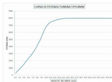
*Caratteristiche Aerogeneratore tipo*
