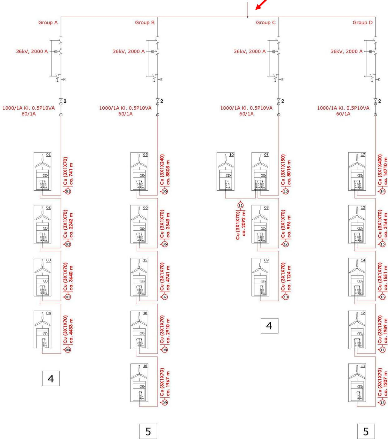
Dettaglio schema elettrico unifilare
