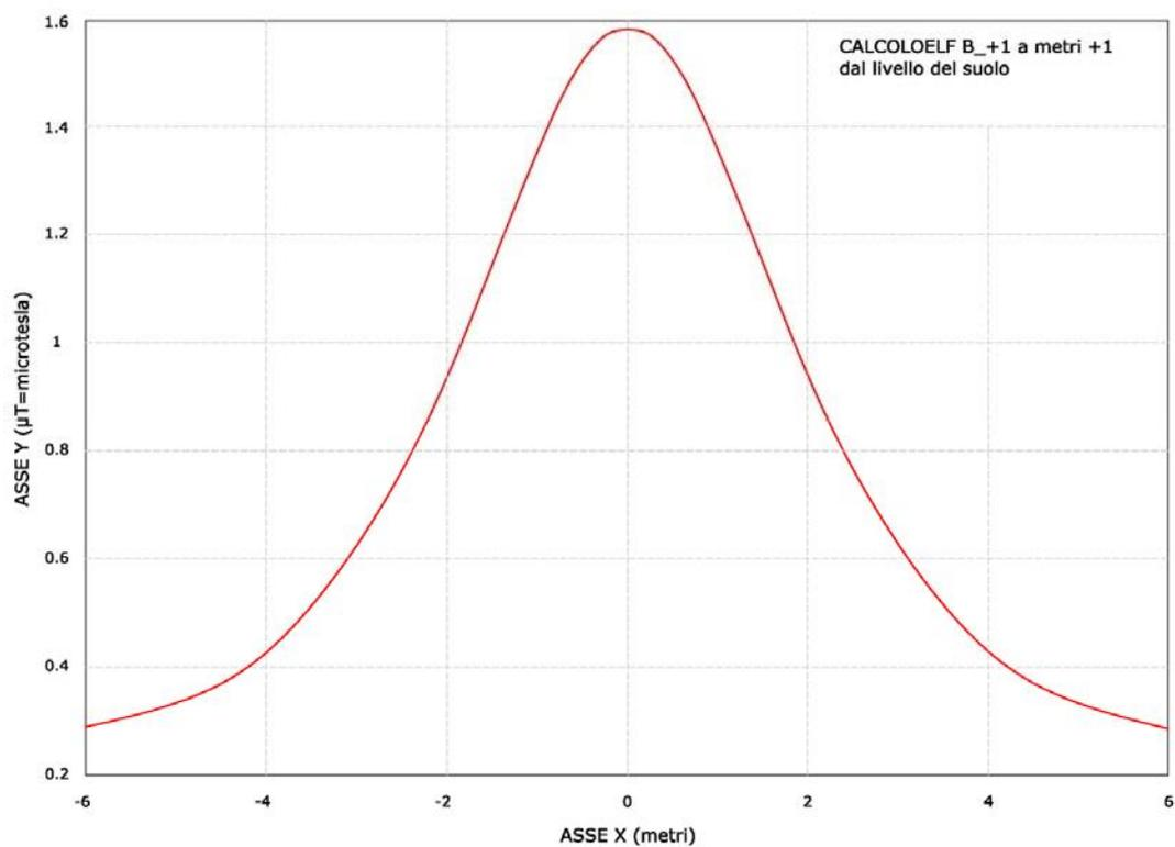
Diagramma campo magnetico delle linee MT interrate in cavo elicordato a quota +1 m dal suolo
