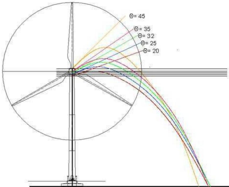
In conclusione scegliendo il valore che rappresenta le condizioni più gravose ossia quello con un angolo di lancio  $\theta = 27^\circ$  e sommando la sua distanza orizzontale dal baricentro e la distanza del vertice della pala (56,67 m) si ha la distanza massima degli elementi rotanti in caso di rottura accidentale è di circa 265,12 m.
