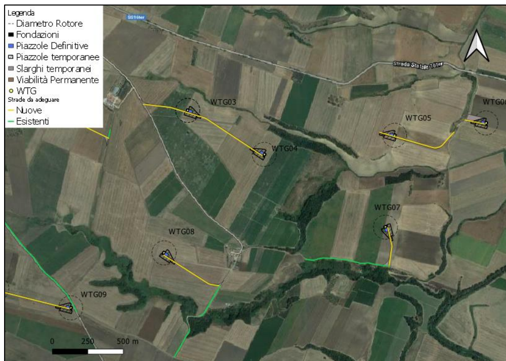
Stralcio viabilità di cantiere – WTG 3-4-5-6-7-8-9
