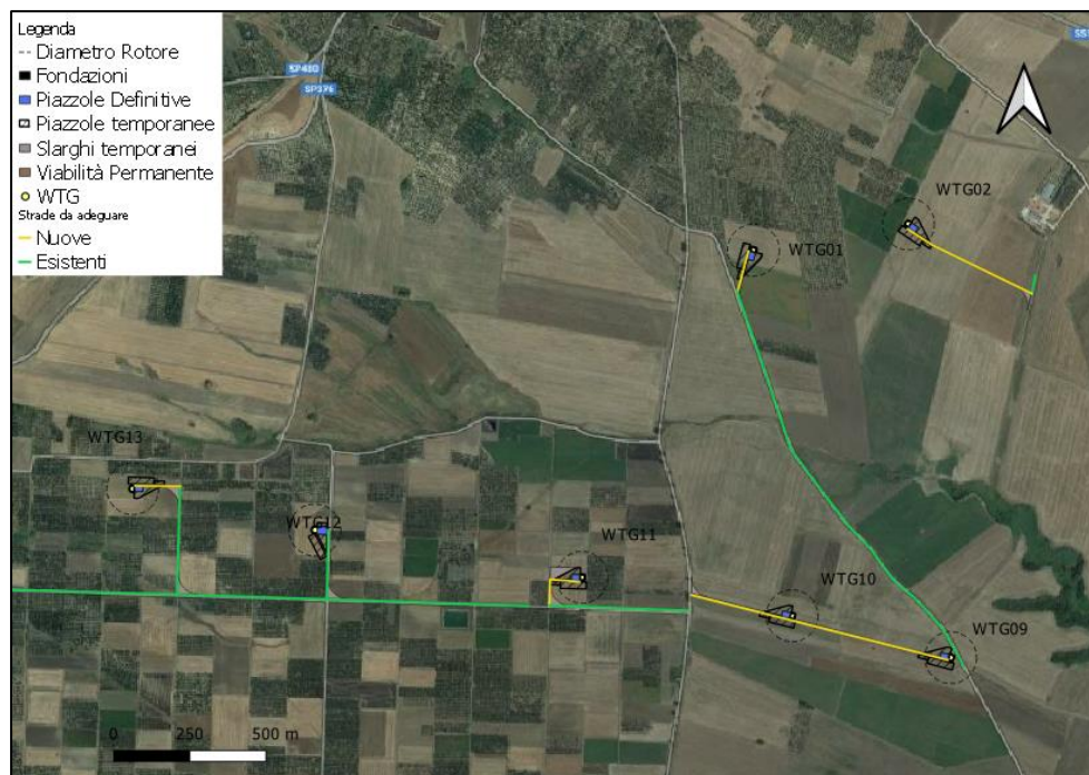
Stralcio viabilità di cantiere – WTG 1-2-9-10-11-12-13
