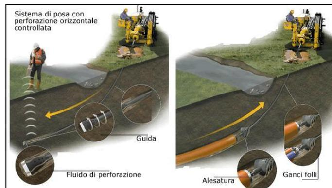
Fig. 1.10: Posa in opera tubazione per alloggio cavi
