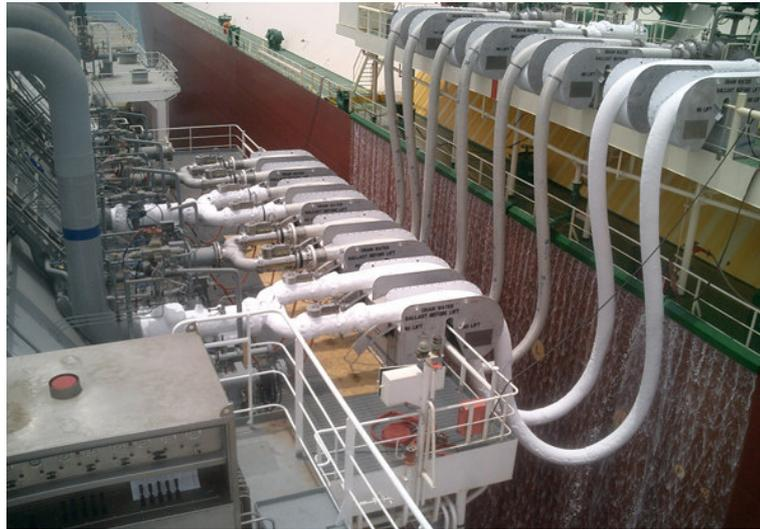
Figura 4 - Trasferimento con manichette (fotografia indicativa a titolo di esempio)
