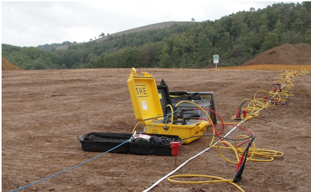
Figura 2 - Indagine sismica - Down Hole
