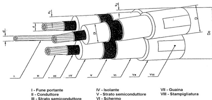
*Figura 20 - Esempio di cavo*
