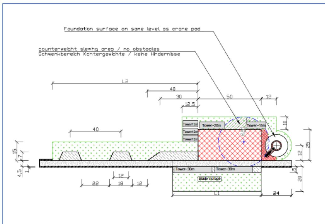
*Figura 19 – tipologico della piazzola di montaggio*
