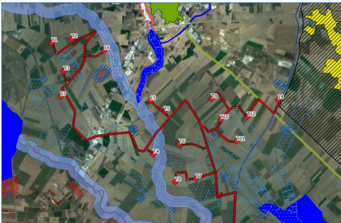
Figura 5 - Ipotesi di layout a 16 aerogeneratori - analisi vincolistica
