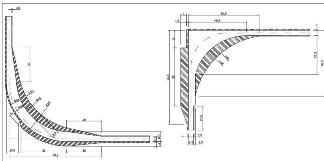
*Figura 15 - Particolare realizzazione raccordo strade*
