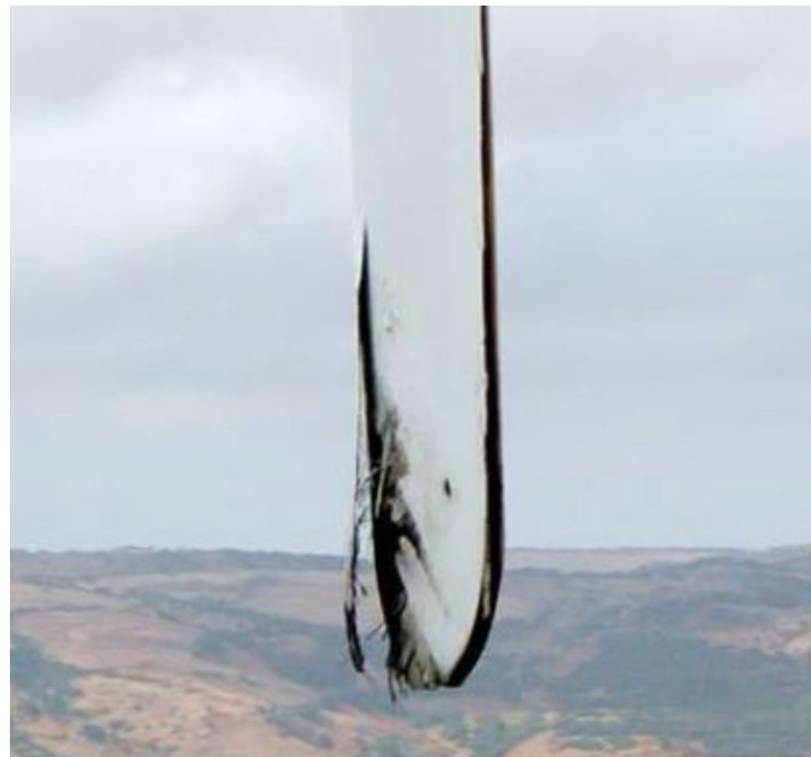
Figura 1 - Estremità della pala danneggiata da fulminazione atmosferica
