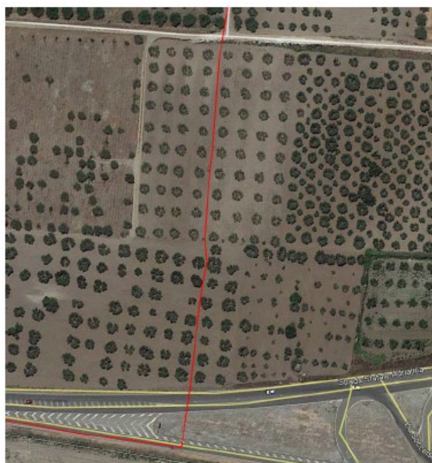
Figura 17 - Attraversamento di un oliveto del cavidotto di connessione esterno MT, nei pressi della SS 16 Adriatica
