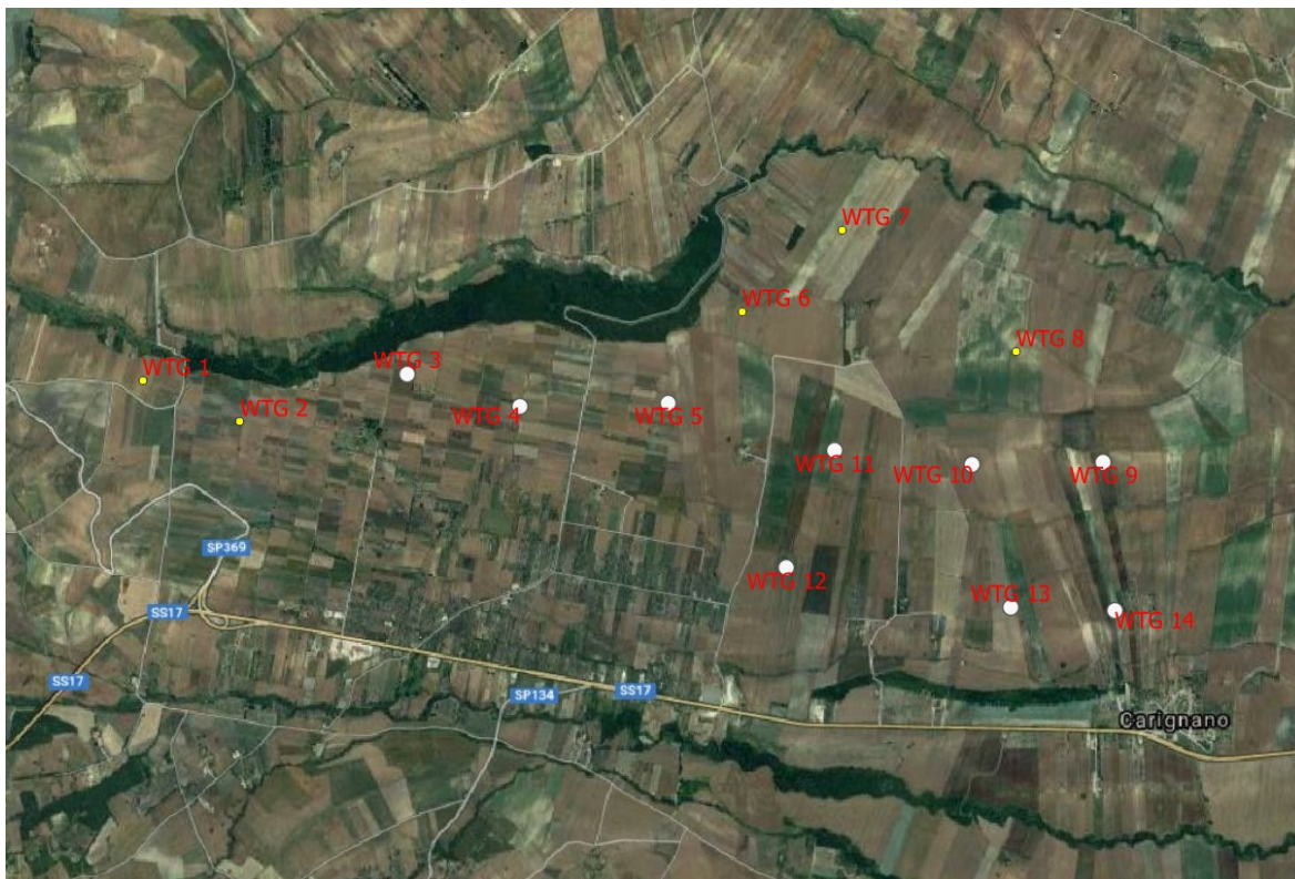
Nuovo layout di impianto su ortofoto – in giallo le WTG eliminate
