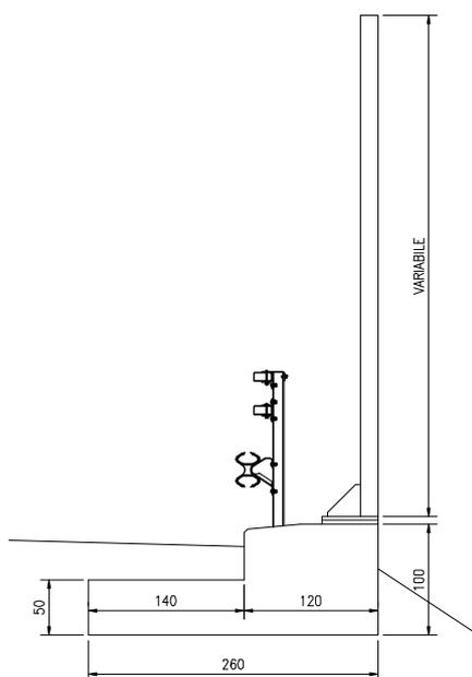
Le barriere antirumore si svilupperanno prevalentemente in fregio alla corsia di emergenza e saranno di altezza variabile, compresa tra 3.00 e 6.00 metri a seconda di quanto richiesto dalle simulazioni.
