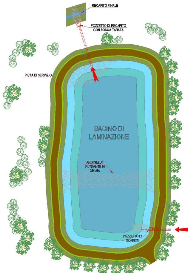
Si riporta nel seguito lo schema di calcolo per il dimensionamento dei volumi di laminazione collegati al concetto di invarianza.
