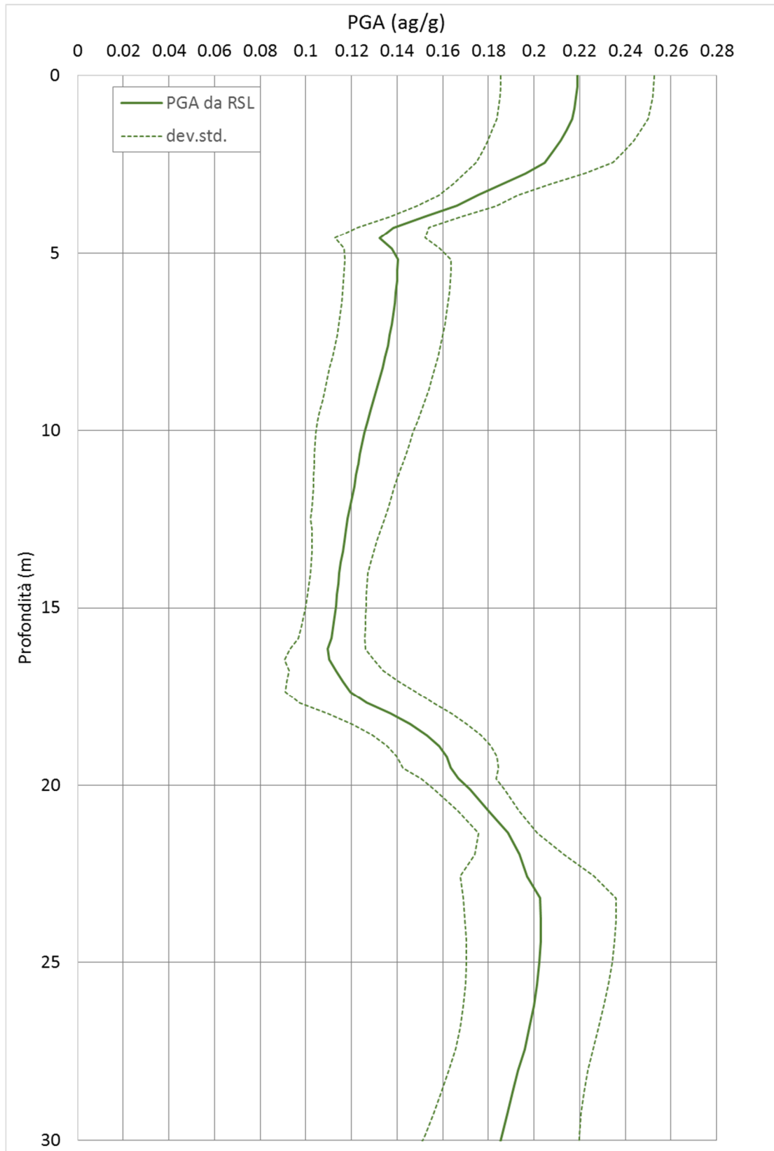
Fig. 33 – Profilo della PGA dal bedrock alla superficie
