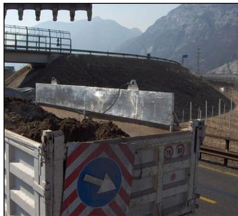
Foto 3 Protezione laterale dei mezzi d'opera
