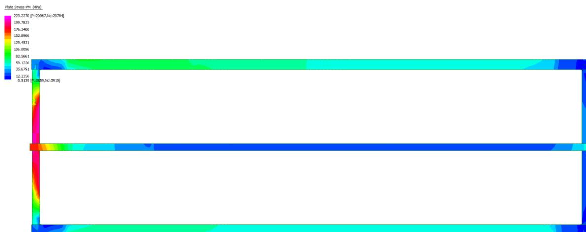
Figura 81 – visualizzazione sollecitazioni piattabanda inferiore per la combinazione di carichi che massimizza il taglio in corrispondenza della pila
