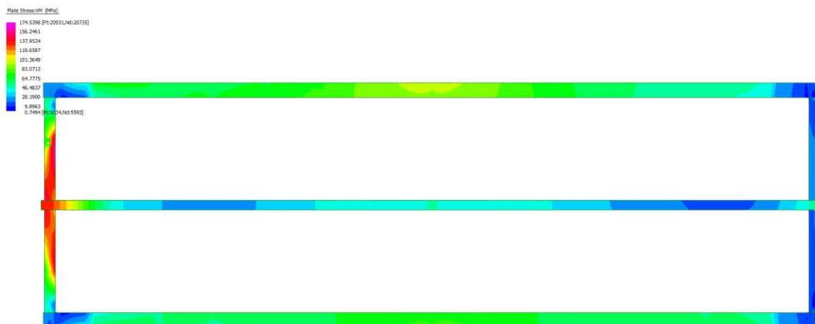
Figura 80 – visualizzazione sollecitazioni piattabanda inferiore per la combinazione di carichi che massimizza la flessione
