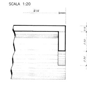
SEZIONE TRAVERSO SULLA SPALLA
