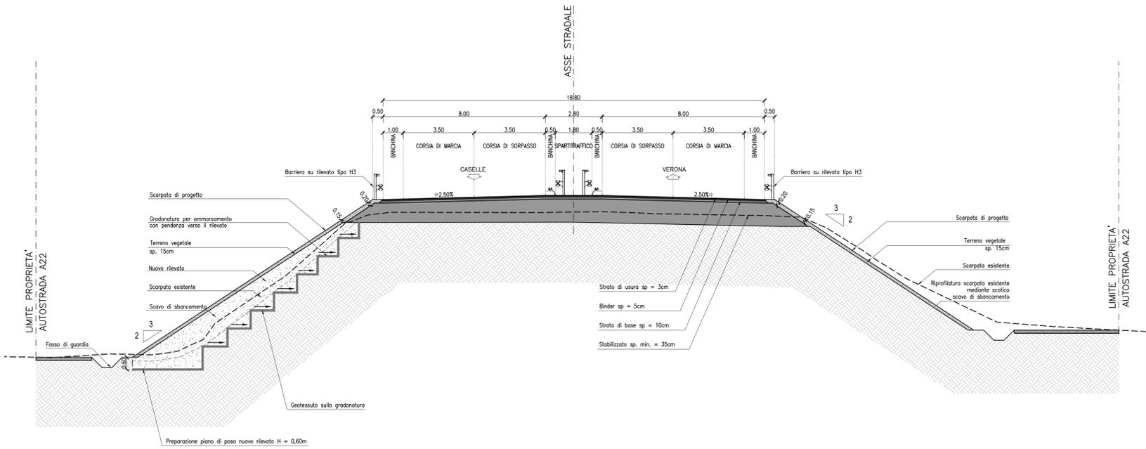
PARTICOLARE BANCHINA E PAVIMENTAZIONE SU RILEVATO
