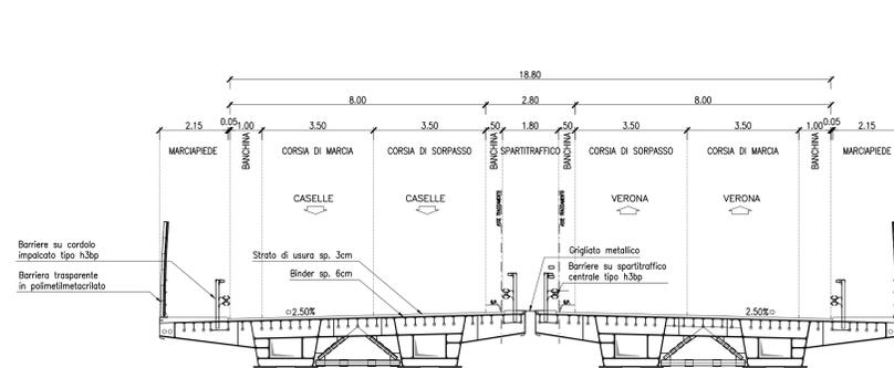
SEZIONE TIPO PAVIMENTAZIONE SU IMPALCATO
