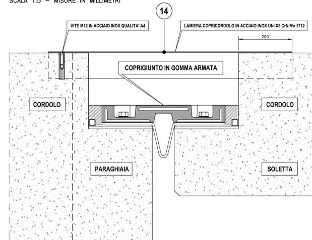
GIUNTO DI DILATAZIONE CON COPRIGIUNTO DEL TIPO IN NEOPRENE CON INSERTI METALLICI VULCANIZZATI
