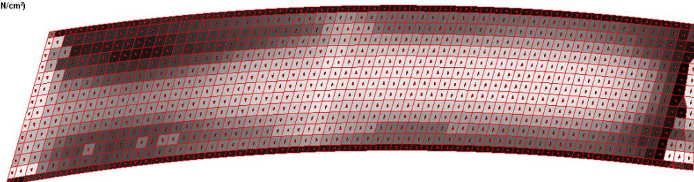
Figura 5.63 Verifica Sismica manteriale Cls 32/40 Dir.2 Intradosso a compressione
