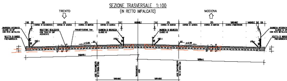
Figura 1.5 Sezione trasversale
