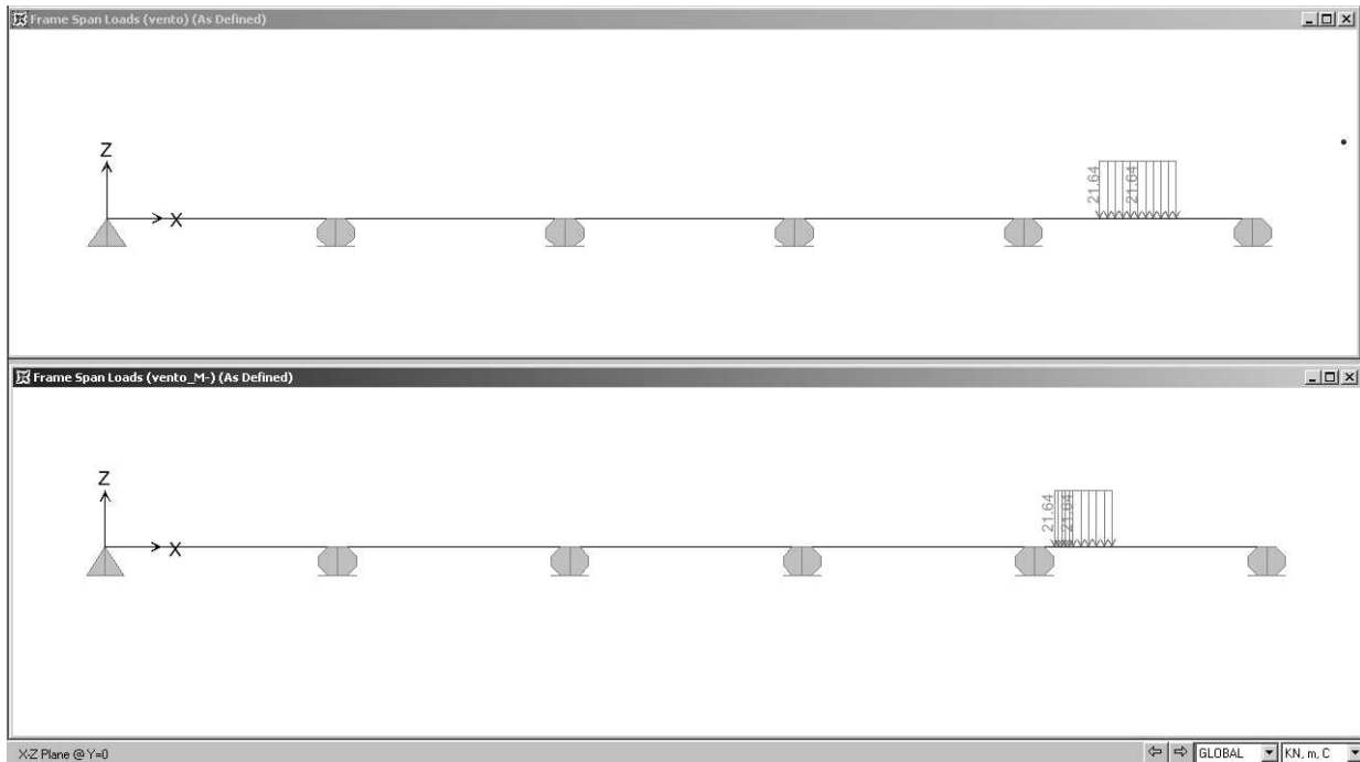
Figura 6-13 Condizioni di carico relative al vento
