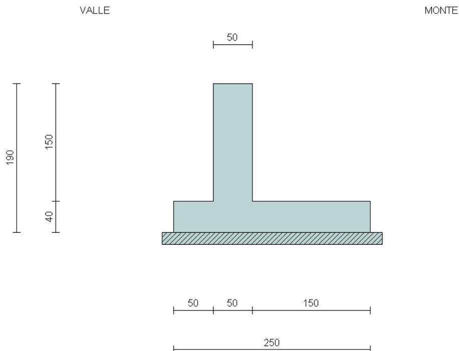
In figura è rappresentata la schematizzazione effettuata per le verifiche con il software MAX10; tale modellazione non comprende il cordolo, di dimensioni  $1,20 \times 0,50\text{m}$ ; si rimanda al *paragrafo 1.6* per i dettagli sulle modalità di calcolo.
