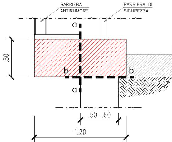
Si verificano le sezioni a-a e b-b illustrate in figura, precisando che si adottano nel calcolo le caratteristiche geometriche e meccaniche più sfavorevoli per tutti i casi che si possono presentare; la verifica della sezione a-a ha validità generale invece per la sezione b-b si adotta nel calcolo la base minima (pari a 50 cm) per ottenere il caso più sfavorevole.
