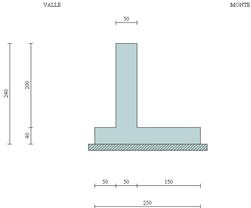
In figura è rappresentata la schematizzazione effettuata per le verifiche con il software MAX10; tale modellazione non comprende il cordolo, di dimensioni  $1,20 \times 0,50\text{m}$ ; si rimanda al *paragrafo 1.6* per i dettagli sulle modalità di calcolo.
