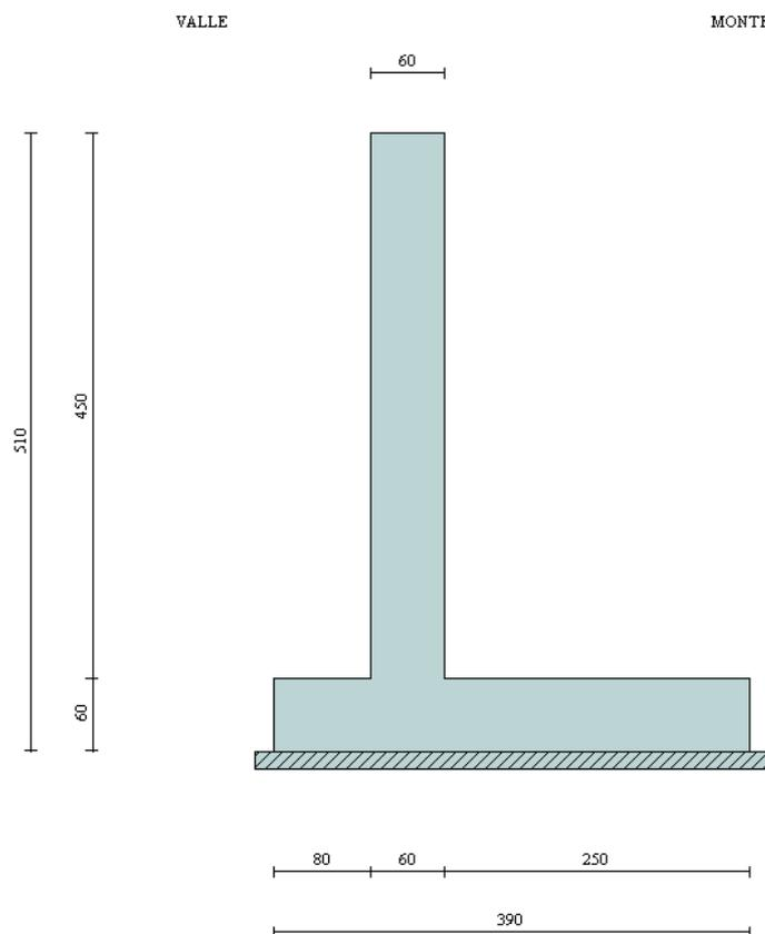
In figura è rappresentata la schematizzazione effettuata per le verifiche con il software MAX10; tale modellazione non comprende il cordolo, di dimensioni 1,20x0,50m; si rimanda al *paragrafo 1.6* per i dettagli sulle modalità di calcolo.
