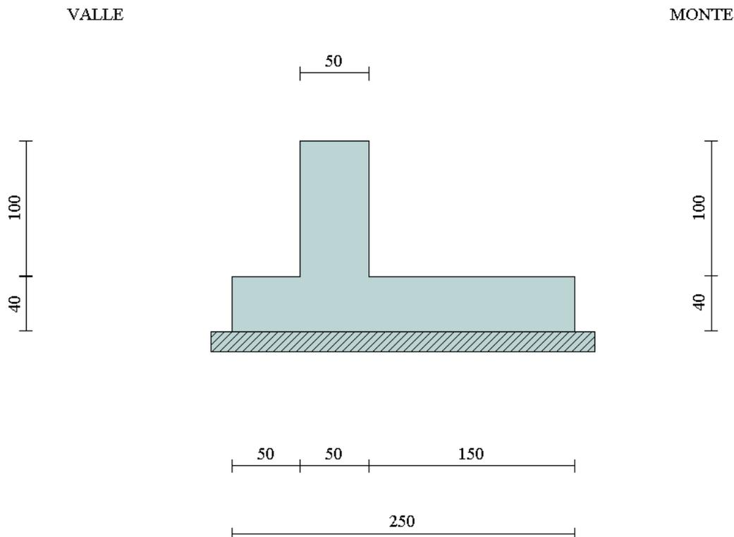
In figura è rappresentata la schematizzazione effettuata per le verifiche con il software MAX10; tale modellazione non comprende il cordolo, di dimensioni 1,20x0,50m; si rimanda al *paragrafo 1.6* per i dettagli sulle modalità di calcolo.
