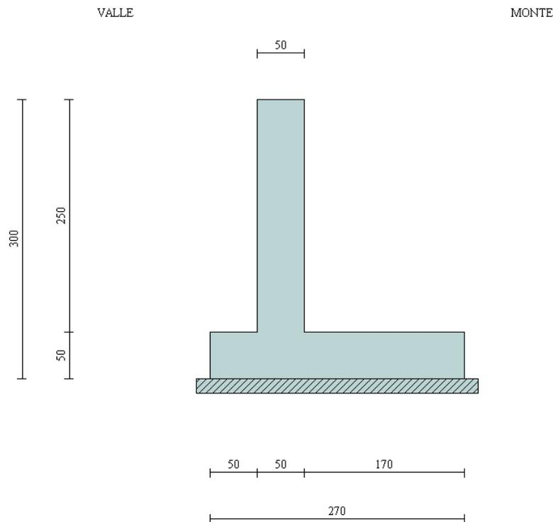
In figura è rappresentata la schematizzazione effettuata per le verifiche con il software MAX10; tale modellazione non comprende il cordolo, di dimensioni 1,20x0,50m; si rimanda al *paragrafo 1.6* per i dettagli sulle modalità di calcolo.
