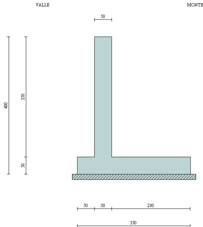
In figura è rappresentata la schematizzazione effettuata per le verifiche con il software MAX10; tale modellazione non comprende il cordolo, di dimensioni 1,20x0,50m; si rimanda al *paragrafo 1.6* per i dettagli sulle modalità di calcolo.
