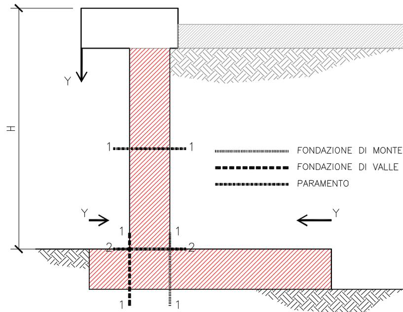
Si precisa che il programma MAX non permette di considerare un numero non intero di armature a metro lineare. Sono stati considerati quindi tre ferri a metro di diametro sufficiente per soddisfare le verifiche delle sezioni; in realtà tutti gli elementi strutturali saranno armati con ferri dello stesso diametro previsto nel programma ma con passo 30 cm; l'armatura inserita effettivamente sarà quindi superiore a quella considerata nelle verifiche.
