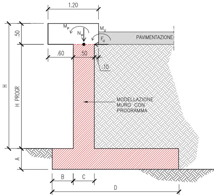
La modellazione del cordolo non è stata eseguita; si considera infatti la pavimentazione come un peso che genera quindi solo spinta orizzontale costante lungo l'altezza. La modellazione del cordolo non è necessaria anche perchè le caratteristiche geometriche e di armatura dello stesso sono indipendenti dall'altezza del muro. È infatti previsto un cordolo di dimensioni 1.20x0.50m, le cui verifiche saranno oggetto di specifica analisi nel *paragrafo 1.8*.
