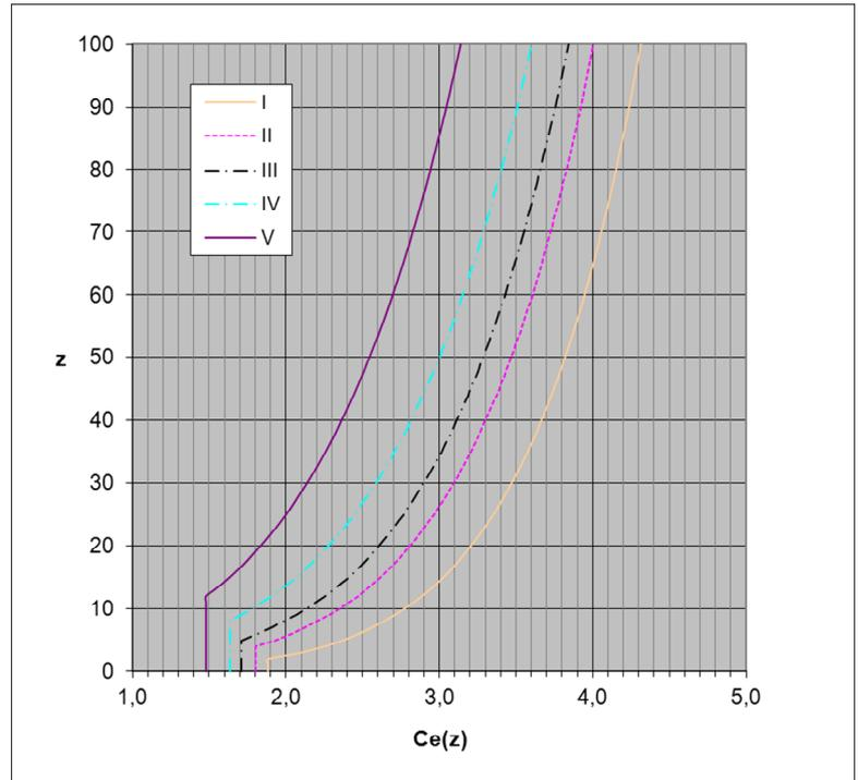
Assumendo  $C_t = 1.0$ , classe di rugosità più sfavorevole pari a "D", ipotizzando la categoria di esposizione più sfavorevole ("II") e valutando prudenzialmente il coefficiente  $C_e$  in corrispondenza della quota massima del manufatto ( $z = 5.50 \text{ m} > z_{\min} = 4.00 \text{ m}$ ), si ottiene:
