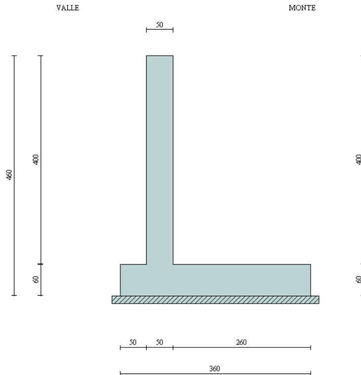
In figura è rappresentata la schematizzazione effettuata per le verifiche con il software MAX10; tale modellazione non comprende il cordolo, di dimensioni 1,20x0,50m; si rimanda al *paragrafo 1.6* per i dettagli sulle modalità di calcolo.
