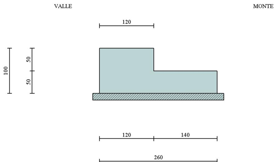
In figura è rappresentata la schematizzazione effettuata per le verifiche con il software MAX10; tale modellazione non comprende il cordolo, di dimensioni 1,20x0,50m; si rimanda al *paragrafo 1.6* per i dettagli sulle modalità di calcolo.
