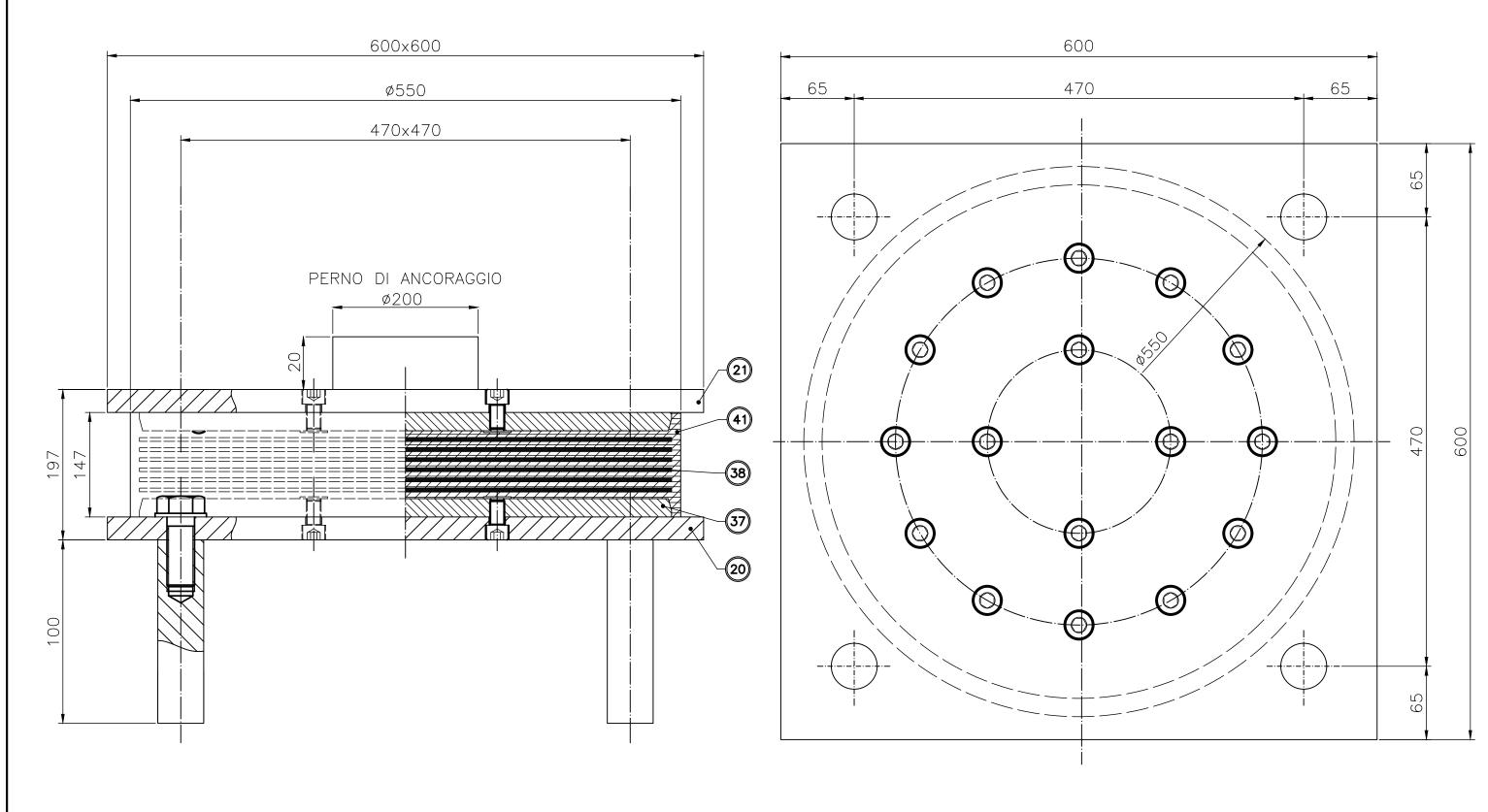
ISOLATORE ELASTOMERICO FIP SI-N550/77 O EQUIVALENTE (spostamento 150 mm)
