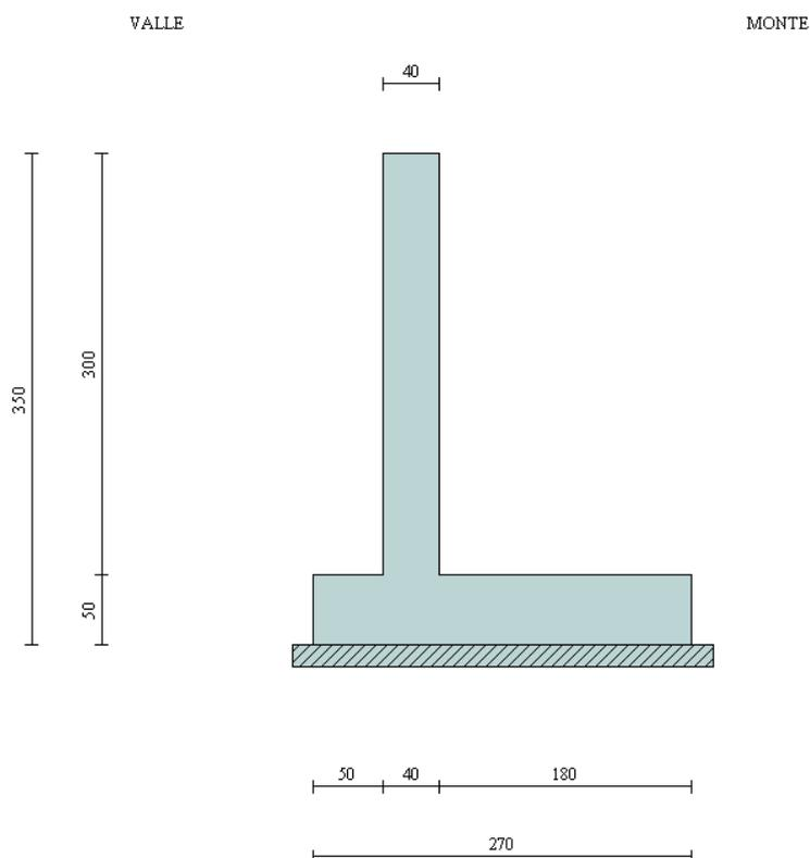
In figura è rappresentata la schematizzazione effettuata per le verifiche con il software MAX10; tale modellazione non comprende il cordolo, di dimensioni 0,60x0,50m, considerato come peso in sede di analisi dei carichi; si rimanda al *paragrafo 1.6* per i dettagli sulle modalità di calcolo.
