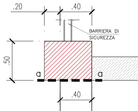
Si riporta la verifica della sezione di sommità del muro, precisando che anche in questo caso l'armatura è indipendente dall'altezza del muro.
