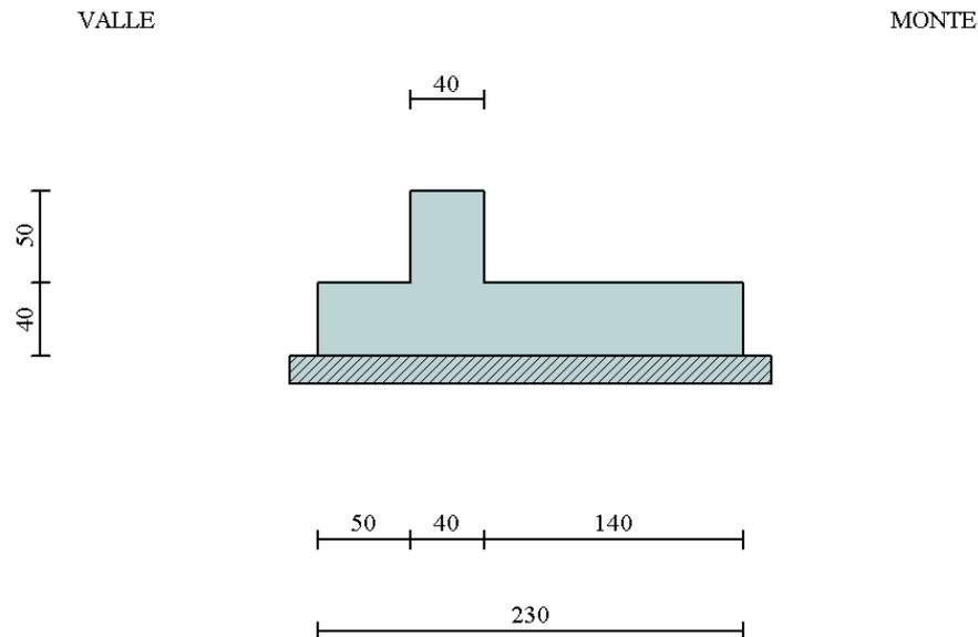
In figura è rappresentata la schematizzazione effettuata per le verifiche con il software MAX10; tale modellazione non comprende il cordolo, di dimensioni 0,60x0,50m, considerato come peso in sede di analisi dei carichi; si rimanda al *paragrafo 1.6* per i dettagli sulle modalità di calcolo.
