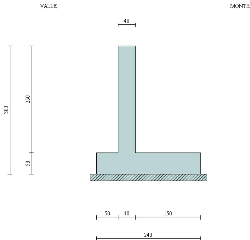
In figura è rappresentata la schematizzazione effettuata per le verifiche con il software MAX10; tale modellazione non comprende il cordolo, di dimensioni  $0,60 \times 0,50$ m, considerato come peso in sede di analisi dei carichi; si rimanda al *paragrafo 1.6* per i dettagli sulle modalità di calcolo.
