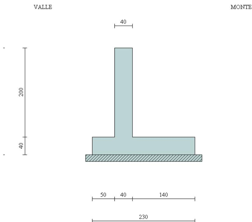
In figura è rappresentata la schematizzazione effettuata per le verifiche con il software MAX10; tale modellazione non comprende il cordolo, di dimensioni  $0,60 \times 0,50\text{m}$ , considerato come peso in sede di analisi dei carichi; si rimanda al *paragrafo 1.6* per i dettagli sulle modalità di calcolo.
