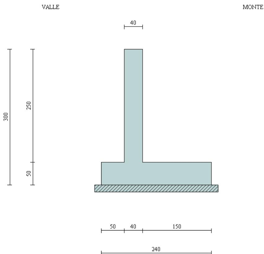
In figura è rappresentata la schematizzazione effettuata per le verifiche con il software MAX10; tale modellazione non comprende il cordolo, di dimensioni 0,60x0,50m, considerato come peso in sede di analisi dei carichi; si rimanda al *paragrafo 1.6* per i dettagli sulle modalità di calcolo.
