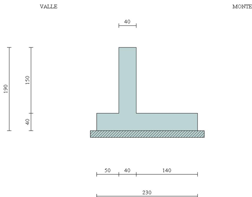
In figura è rappresentata la schematizzazione effettuata per le verifiche con il software MAX10; tale modellazione non comprende il cordolo, di dimensioni  $0,60 \times 0,50\text{m}$ , considerato come peso in sede di analisi dei carichi; si rimanda al *paragrafo 1.6* per i dettagli sulle modalità di calcolo.
