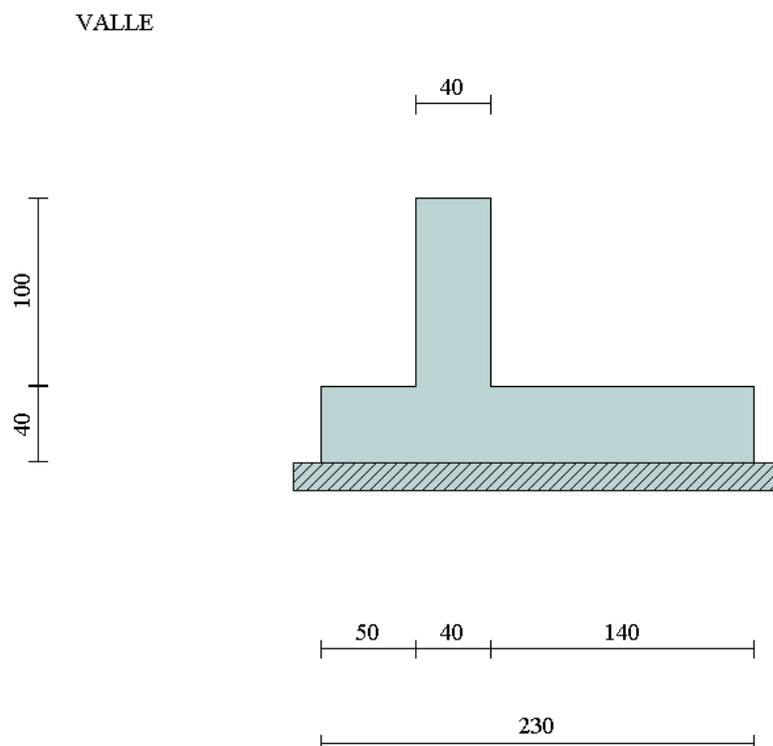
In figura è rappresentata la schematizzazione effettuata per le verifiche con il software MAX10; tale modellazione non comprende il cordolo, di dimensioni  $0,60 \times 0,50\text{m}$ , considerato come peso in sede di analisi dei carichi; si rimanda al *paragrafo 1.6* per i dettagli sulle modalità di calcolo.
