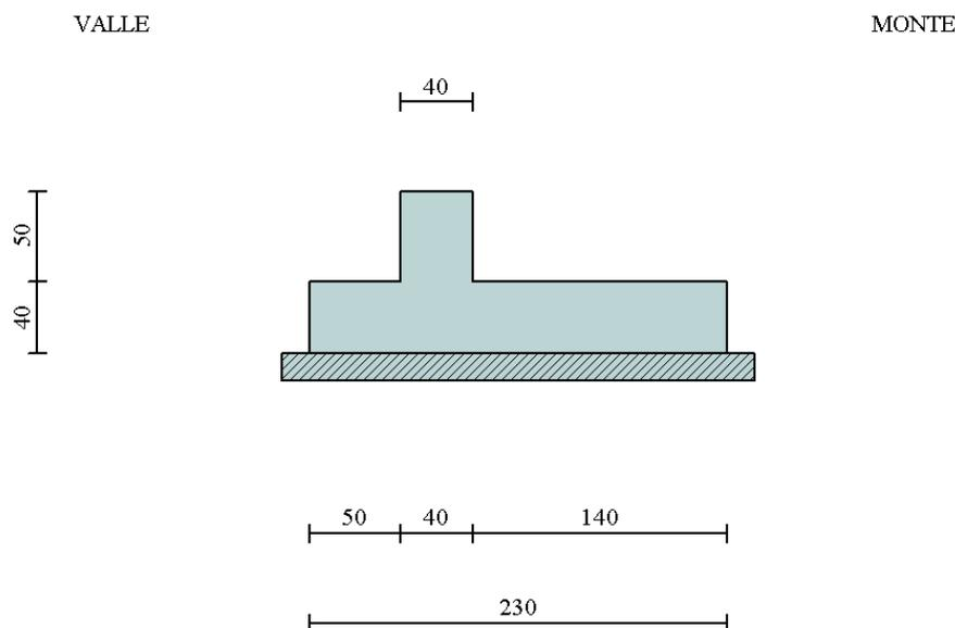
In figura è rappresentata la schematizzazione effettuata per le verifiche con il software MAX10; tale modellazione non comprende il cordolo, di dimensioni 0,60x0,50m, considerato come peso in sede di analisi dei carichi; si rimanda al *paragrafo 1.6* per i dettagli sulle modalità di calcolo.
