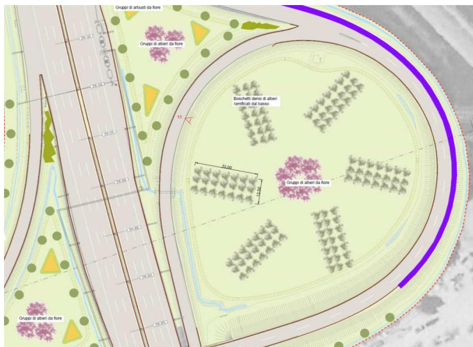
Figura 72: Progetto di sistemazione a verde dell'area circolare all'interno dello svincolo di Pegognaga
