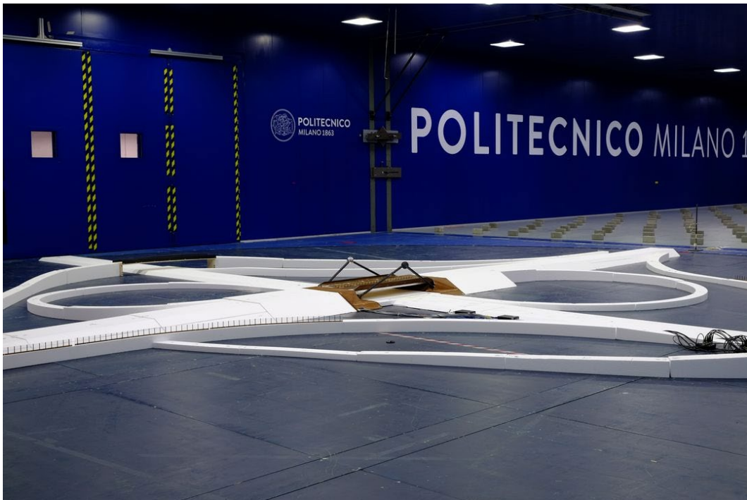
Figura 5-6. Bridge A. Modello in camera di prova.
