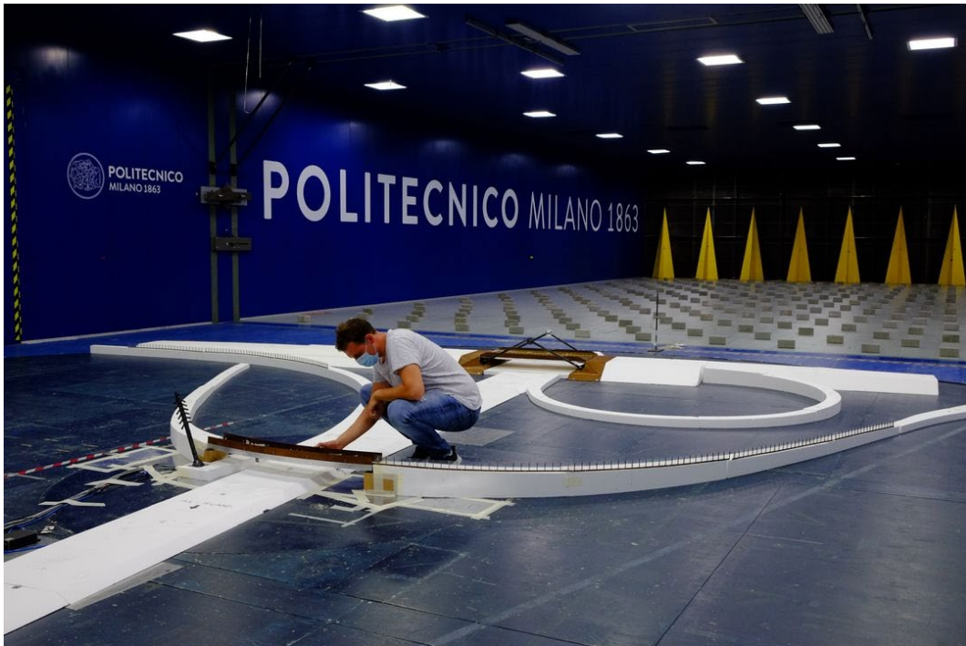
Figura 5-7. Bridge B. Modello in camera di prova.
