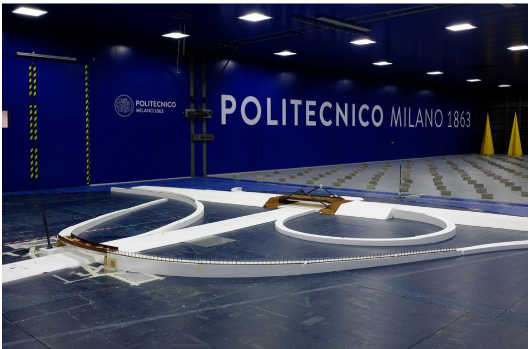
Figura 5-8. Bridge B. Modello in camera di prova.
