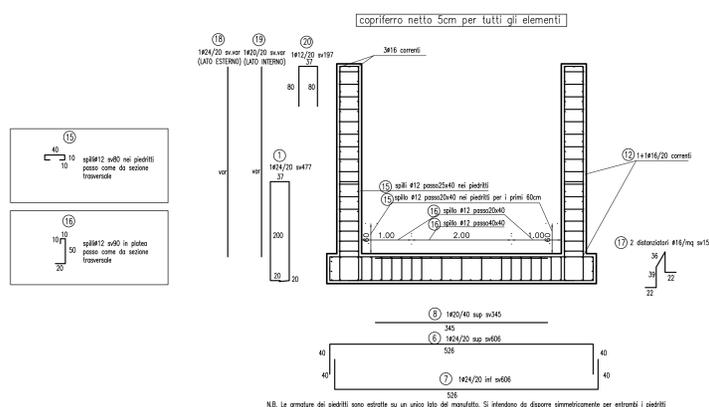
SEZIONE B-B: ARMATURA TIPO 2
