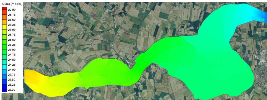
Figura 34 - Distribuzione planimetrica delle quote assolute nell'istante di transito del picco di piena in corrispondenza del ponte autostradale
